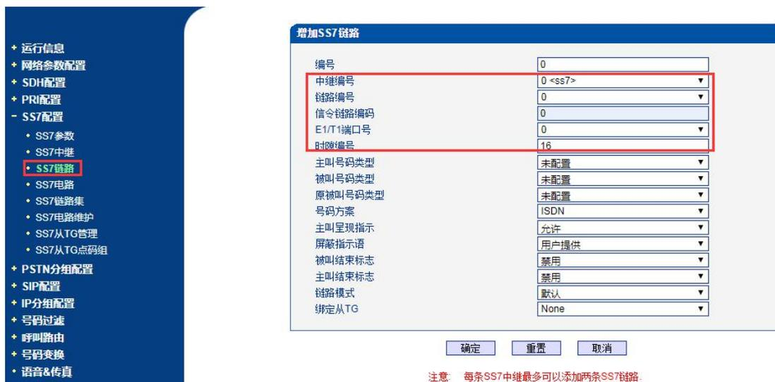
如果运营商开了两条链路，那么继续再添加一条 SS7 链路，添加第二条链路时将只链路编码选择 1，信令链路编码也配置 1，然后再选择链路所在 E1 端口和时隙。
