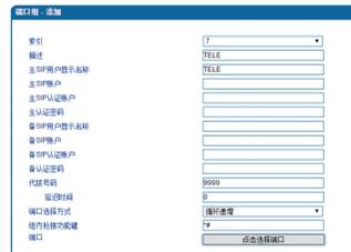
代拨号码为外线呼入到服务器的直接拨入号(DID)，单击“点击选择端口”按钮设定该端口组包含哪些外线端口。
